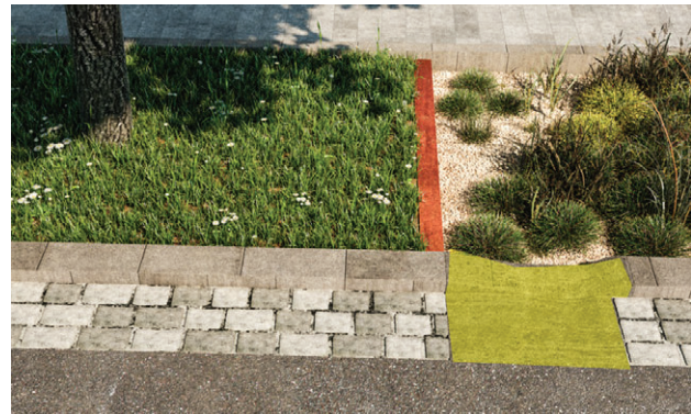
Abb.82 Einlaufelement in Mulde
